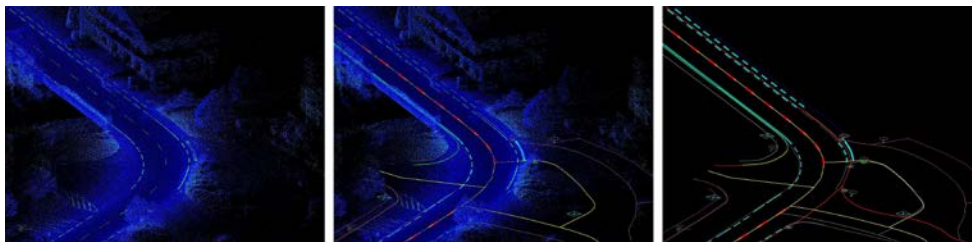
Abbildung 10: Von der Punktwolke zur HD Map © AIT
