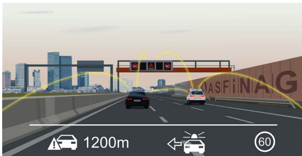
Abbildung 14: C-ITS: direkte Kommunikation zwischen Fahrzeugen und Infrastruktur © ASFINAG
